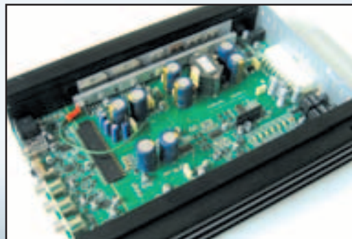
Solide: Der i-soamp erfreut mit hochwertigen Bauteilen und SMD-Bestückung.
