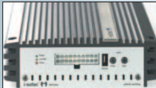
All inclusive: Sämtliche Anschlüsse sind in einem einzigen Stecker zusammengefasst.
