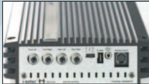
Alternative Leiste: Für Radios mit Vorverstärker-Ausgängen stehen Cinchbuchsen zur Verfügung.
